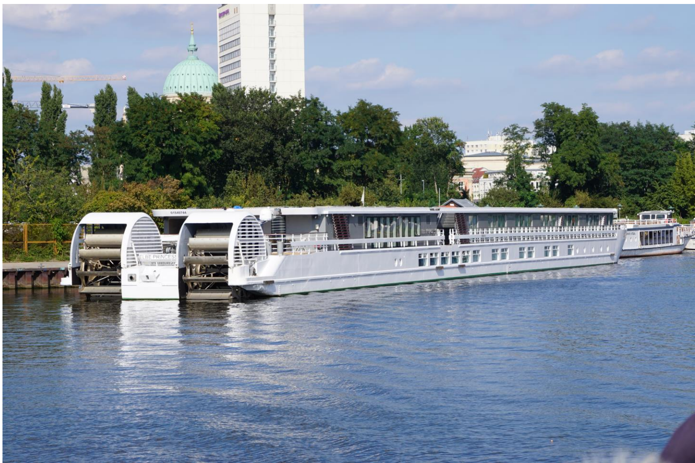
Schaufelradgetriebenes Binnenschiff für die teilweise flachen Havelgewässer in der Potsdamer Gegend.
