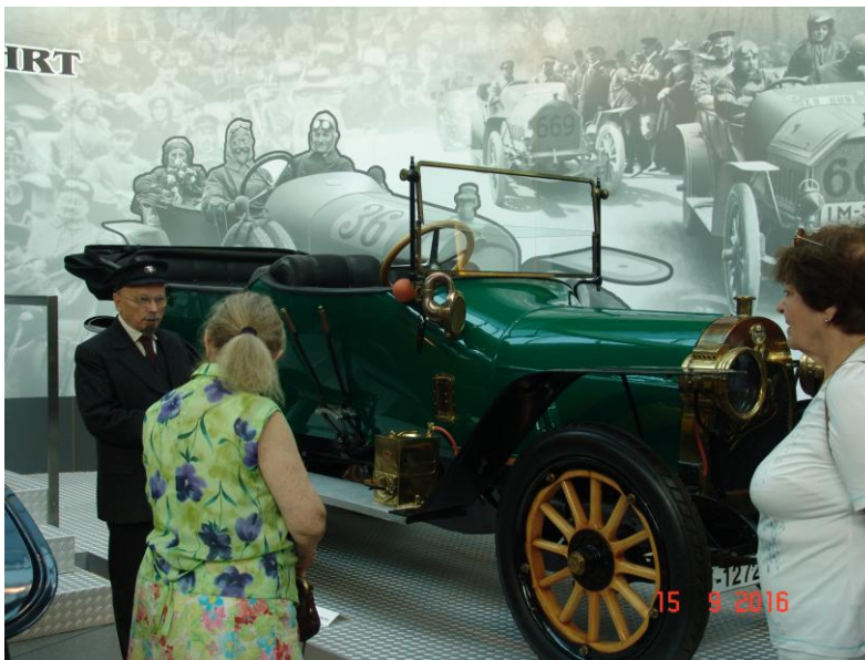
Horch mit Holzfelgen und Erzeuger von Acetylen für die gasbetriebenen Scheinwerfer.
