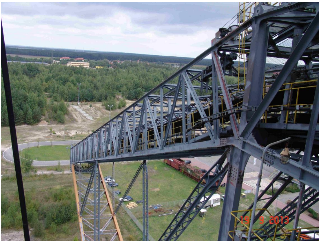
Blick von oben auf einen der rechten, schwenkbaren Seitenausleger. Es gibt sie immer paarweise.
