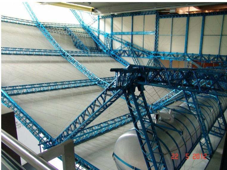
Ganz rechts die Wasser-, Gas- und Dieseltanks und der schmale Laufsteg für das Wartungspersonal. Blau ist die Originalkonstruktion der
