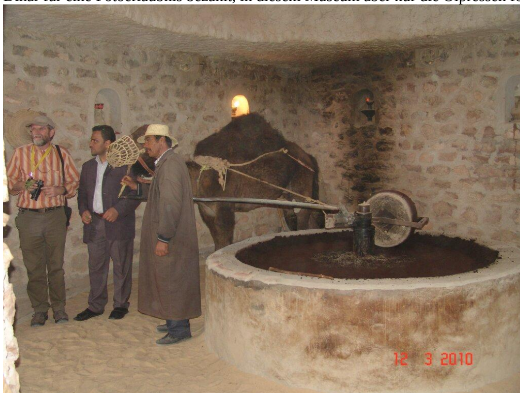
Das im Kreise laufende Kamel bewegt einen schweren Stein, der das Öl kalt aus den Oliven presst.
