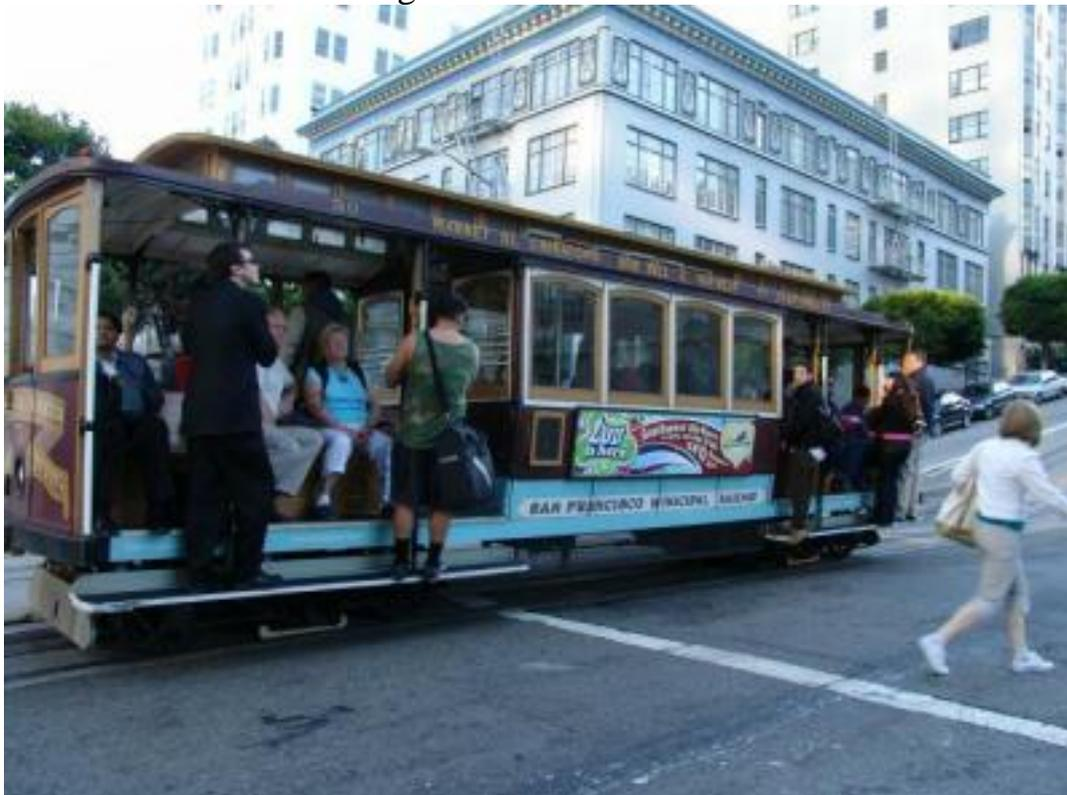
Die Straßen sind teilweise sehr steil - Tod für ein Wohnmobil wegen der vielen Halts an den Ampeln. Deshalb wird die Straßenbahn von (in der Erde über Rollen laufenden) Kabeln gezogen: Cable Car.
