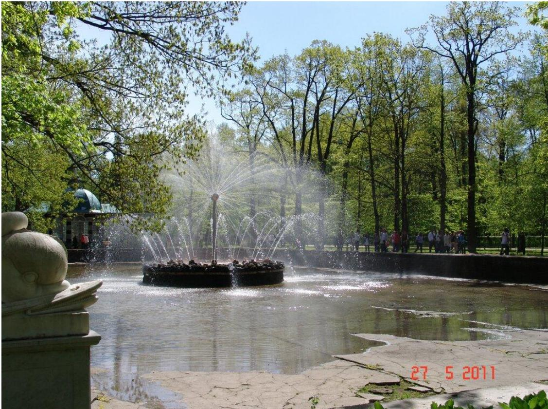
Fontaine „Sonne“. Die aus dem Rohr im Zentrum ausfließenden Wasserstrahlen versetzen das Rohr in langsame Drehung (nach dem Rückstoßprinzip), womit sich auch die Strahlenebene bewegt (d.h., sich dreht)
