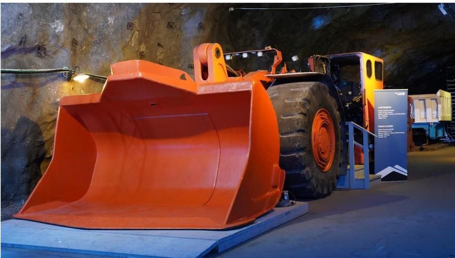
Links der Bagger (Fahrlader) nochmals separat. Mehrere Bohrmaschinen bohren tagsüber Löcher für den Sprengstoff, jede von ihnen bohrt 27 Löcher simultan. Nach Mitternacht wird gesprengt, was etwa 8500 Tonnen Gestein löst, das von den Baggern abtransportiert wird.
