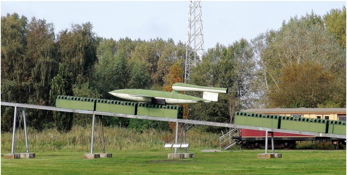
Die Fi 103 (=V1), die auf einer Schiefen Ebene mit einem Beschleuniger auf die Geschwindigkeit von 375 km/h gebracht werden musste, damit das Raketentriebwerk sie dann auf die Flughöhe des anschließenden ballistischen Flugs bringen konnte. Fi steht für Fieseler. V steht für Versuchsmuster, ab 1942 für Vergeltungswaffe. Die V1 ist Vorläufer der heutigen cruise missiles.
